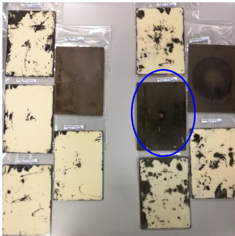
Figura 22. Probetas plasmaactivadas (Fase 1 / 2 tratamiento de plasma) y de control tras someterse a recubrimiento metálico hasta la etapa de Ni químico en instalaciones de empresa colaboradora
