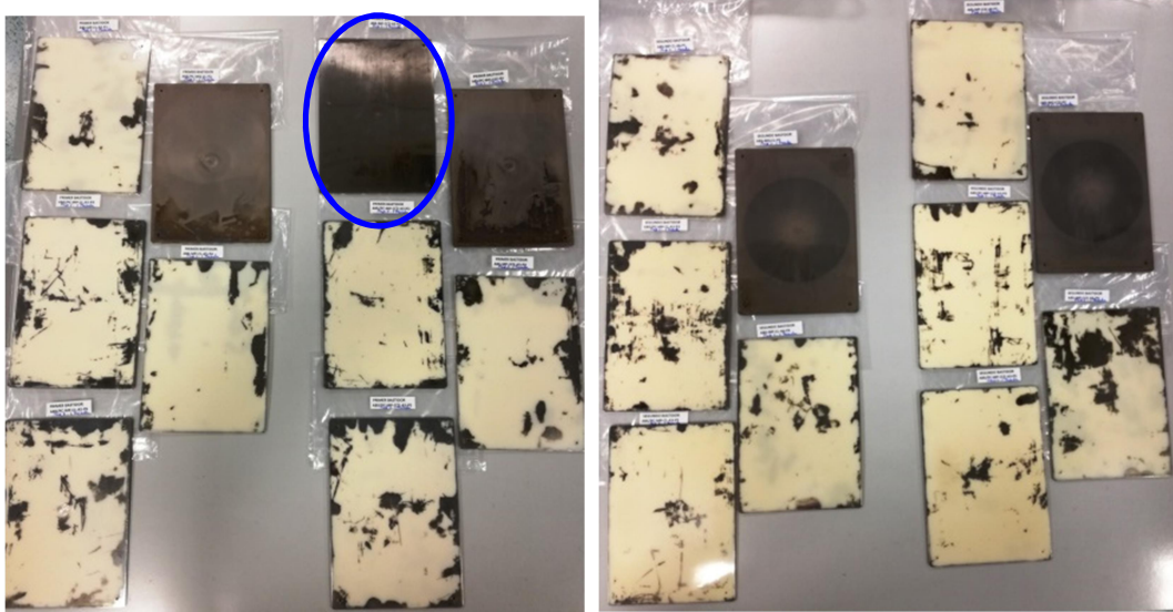
Figura 21. Probetas plasmaactivadas (Fase 1 / 1 tratamiento de plasma) y de control tras someterse a recubrimiento metálico hasta la etapa de Ni químico. (Izda. Primer bastidor / Drcha. Segundo bastidor)
